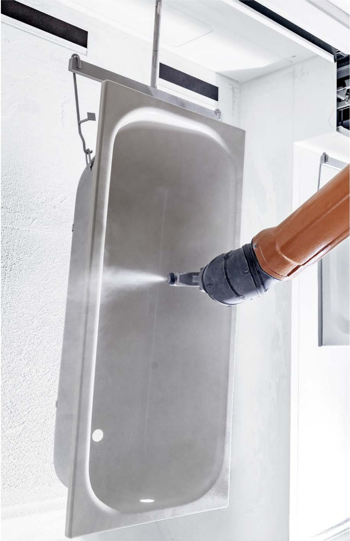
**Emaillieren:** Email verleiht Ihrer Stahlwanne die brillante, kratz- und säurebeständige Oberfläche. Es besteht vollständig aus natürlichen Rohstoffen. Bei hohen Temperaturen werden Borax, Feldspat, Quarz, Soda, Aluminiumoxid und andere Metalloxide zu Emailfritten geschmolzen. Diese sind die Grundstoffe, die es zum Emaillieren braucht.
